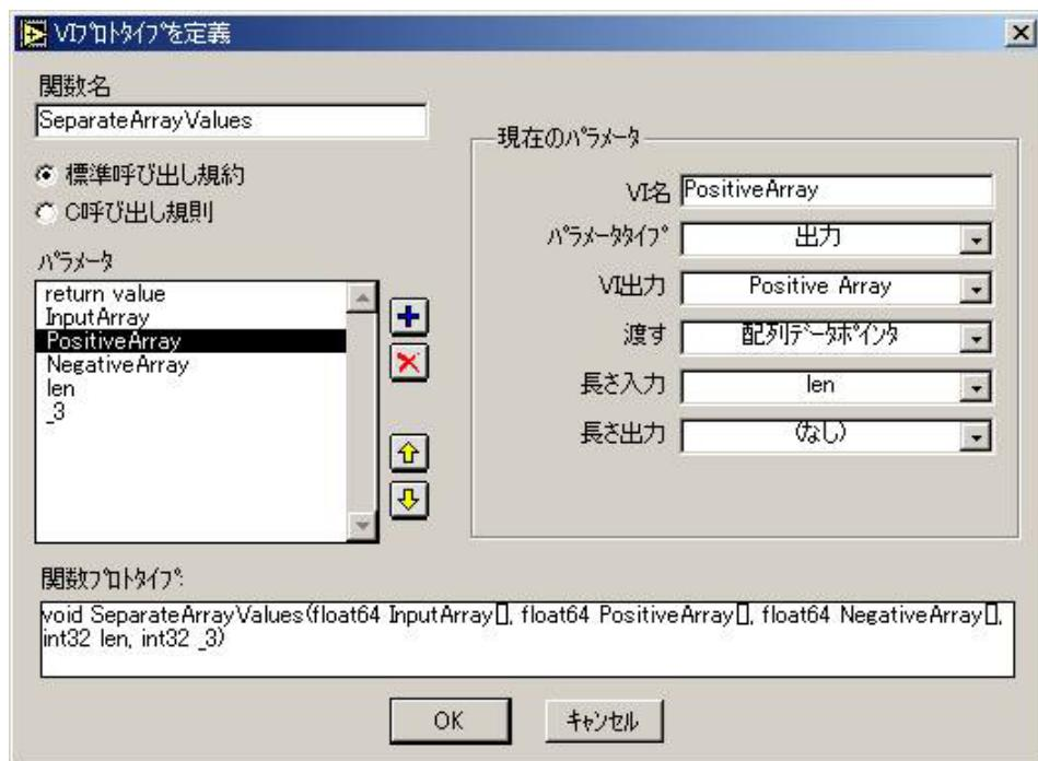
10. NegativeArray を選択して、長さ入力を len に、長さ出力を(なし)を選択して下さい。
