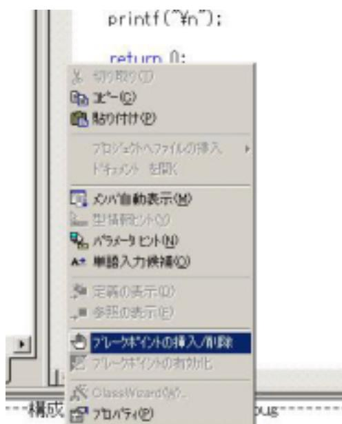
上記の図のように、c ファイルの return 0; をブレークポイントとして設定します。
