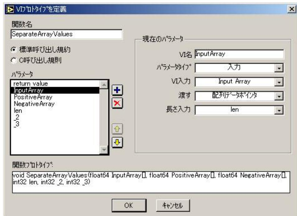
9. 図のように、PositiveArray を選択して、長さ入力を len に、長さ出力を(なし)を選択して下さい。
