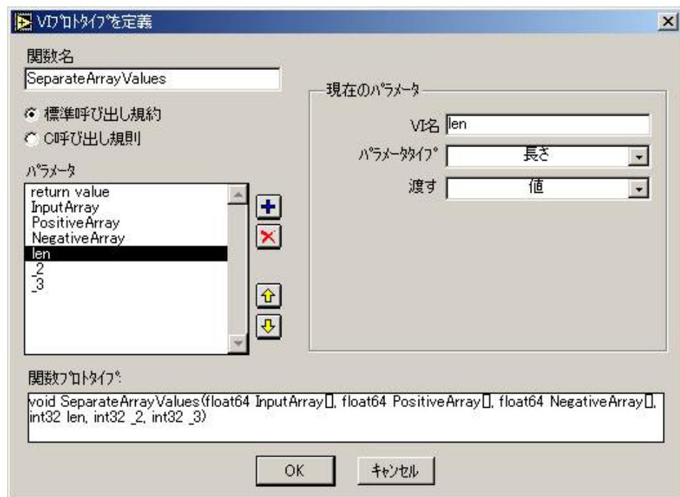
8. 下記の図のように、InputArray を選択して、長さ入力を len に選択して下さい。
