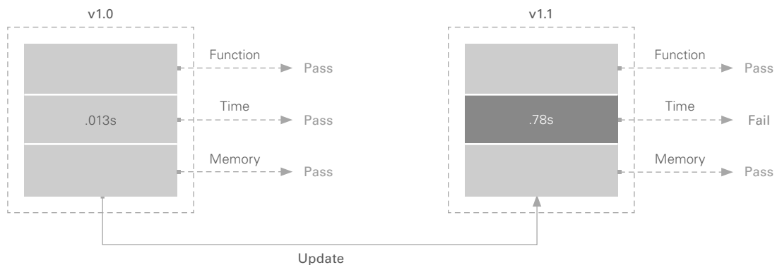
图 8 对v1.0和v1.1执行单元测试后，处理时间被识别为更新后的一项问题，导致过程功能测试出现伪故障
