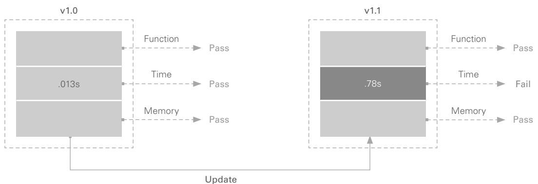
图 8 对v1.0和v1.1执行单元测试后，处理时间被识别为更新后的一项问题，导致过程功能测试出现伪故障
