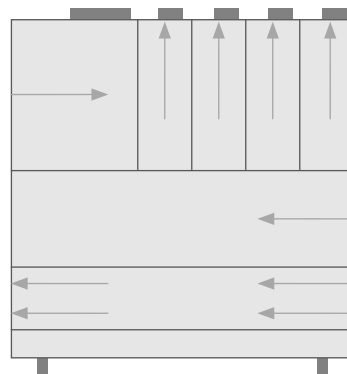
图 5 模块化电源的气流流向俯视图
