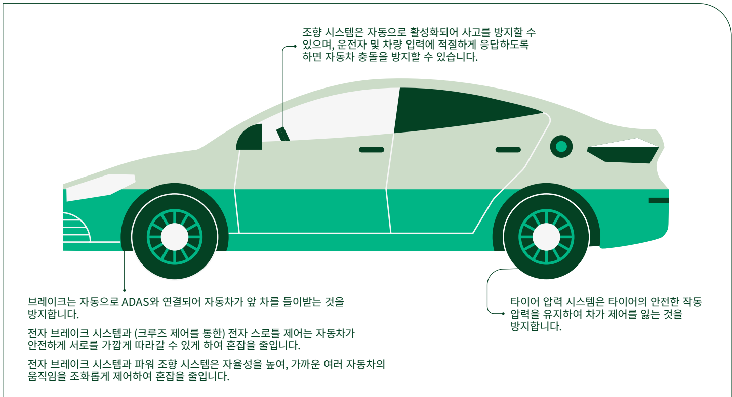
그림 01 Vision Zero에서의 차체와 새시 시스템의 역할
