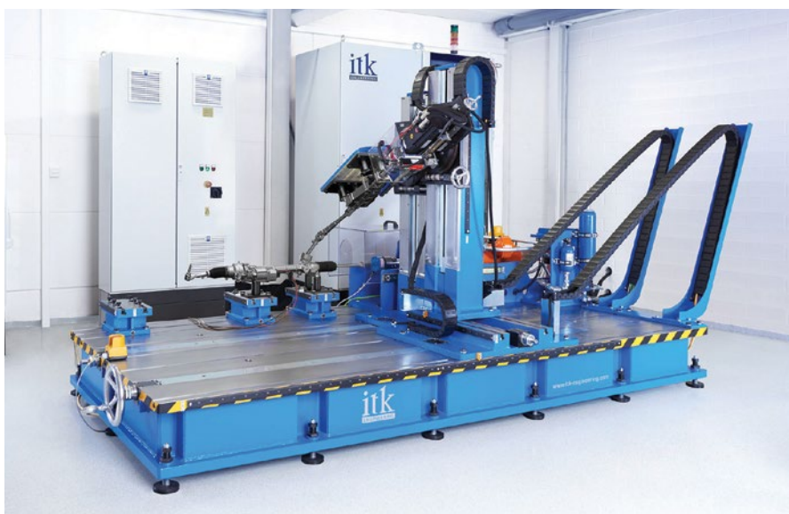
図1. ITKのステアリングテストベンチの機械構造
