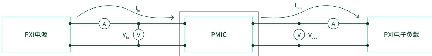
图11 PMIC测试设置简化程序框图
