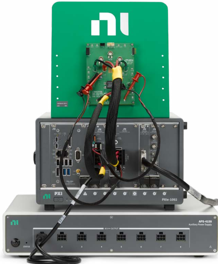
그림 7 LTM4676A 레귤레이터 테스트를 위한 NI PXI 시스템 설정. PXIe-6751 디지털 패턴 계측기, PXIe-4151 300W 전원 공급 장치, DC1811B-B가 포함된 PXIe-4051 300W 전자 로드가 포함됩니다.
