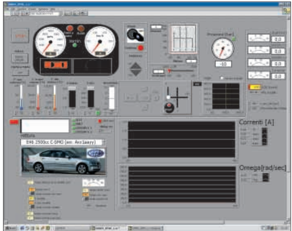
Il pannello di Selespeed in LabVIEW richiama il posto di guida della vettura.
