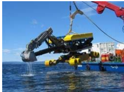
Nexans 使用 NI LabVIEW 和 CompactRIO 控制水压系统，帮助远程控制的蜘蛛挖掘系统在海平面上操作
