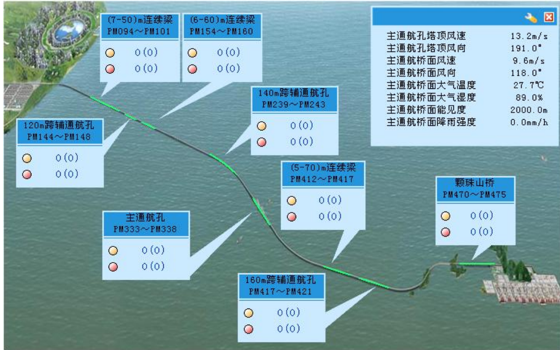
图 1 桥梁健康监测系统的预警监测图
